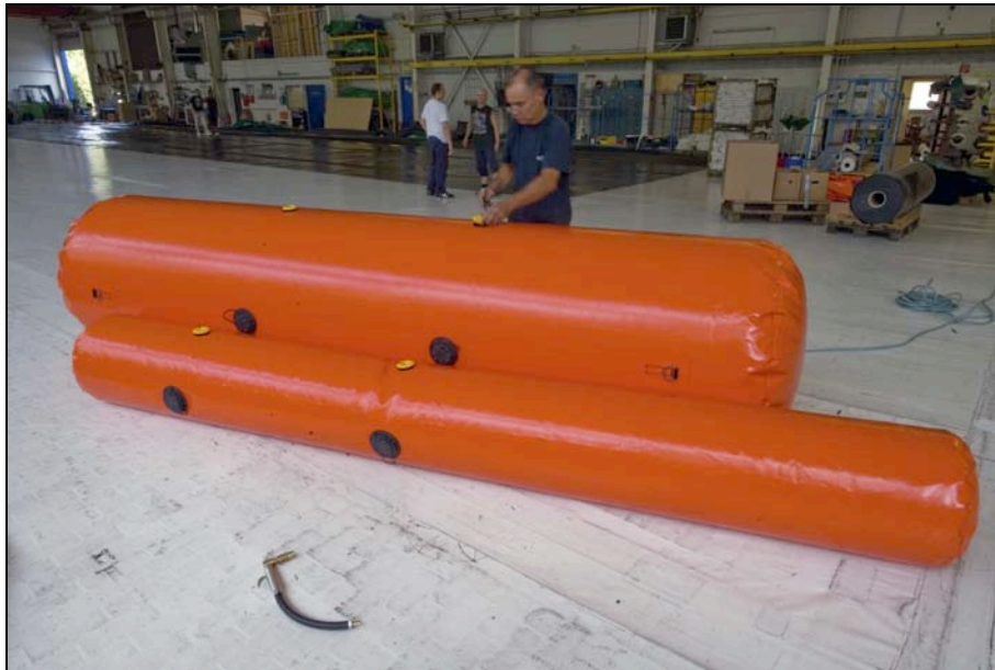
Abb. 7: In Entwicklung befindliches Doppelschlauchsystem der Firma Optimal, Menden (Foto: M.W. Jürgens)
