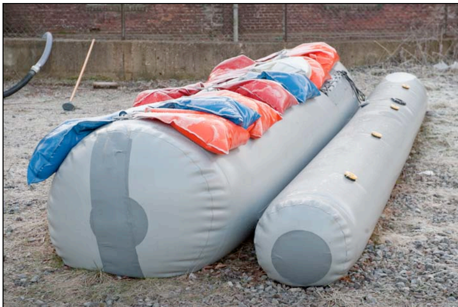
Abb. 11: Wassergefüllter und mit Sandsäcken beschwerter Prototyp nach mehrmonatiger Frostperiode im Januar 2011 auf dem Gelände der Firma Optimal in Menden (Foto: B. Koppe)
