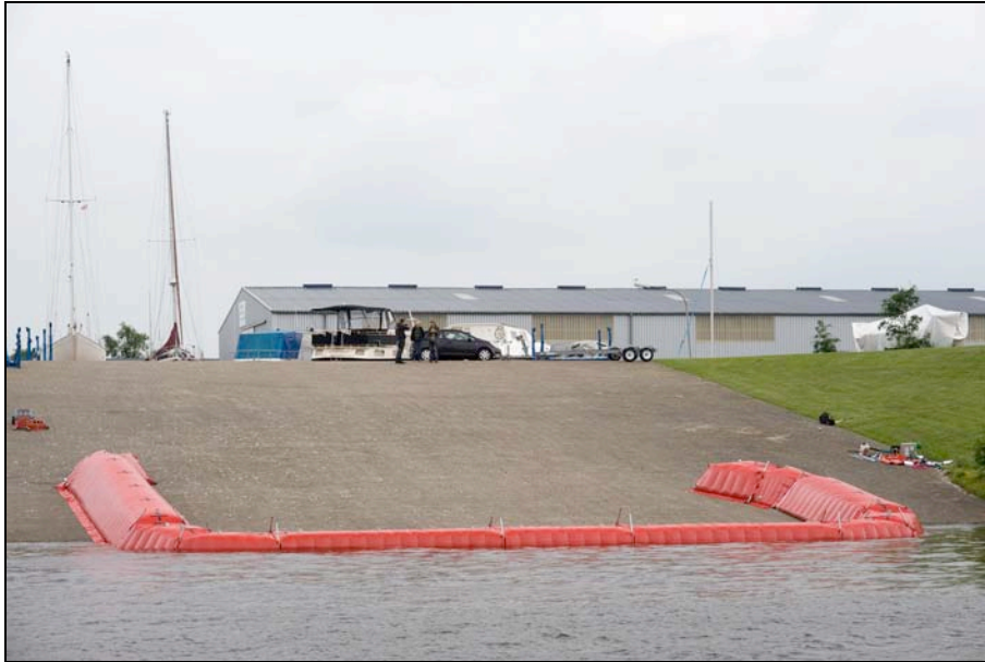
Abb. 6: In Entwicklung befindliches Schlauchsystem mit Innenverspannungen der Firma Karsten Daedler, Trittau, beim Test an der Tideelbe im Juni 2010 (Foto: M.W. Jürgens)
