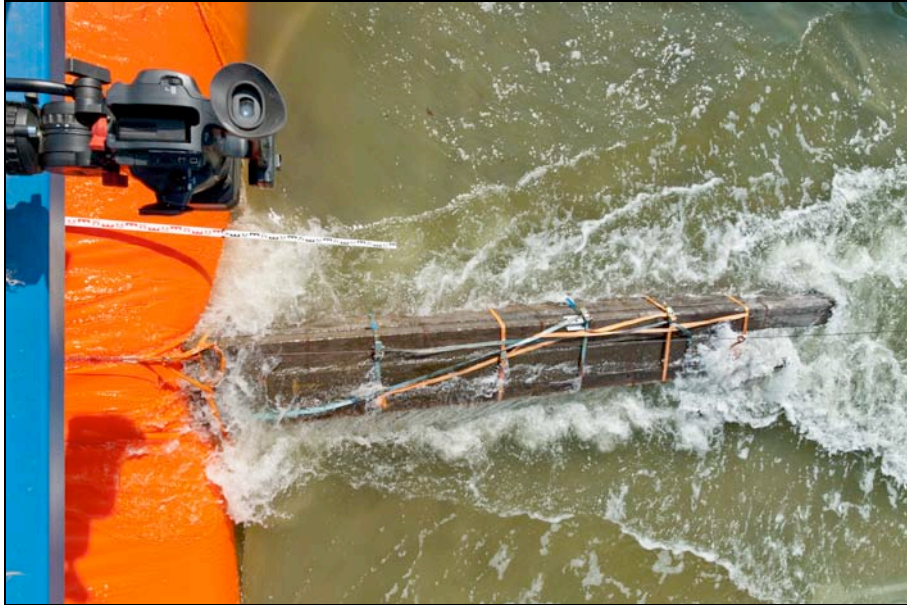
Abb. 10: Aufpralltest im Versuchsstand der TUHH beim Test einer wassergefüllten Schlauchkonstruktion im Kooperationsvorhaben HWS-Mobil im April 2011 (Foto: Koppe)
