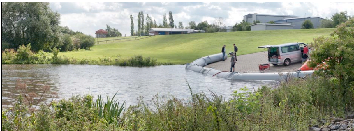
Abb. 8: In Entwicklung befindliches Doppelschlauchsystem der Firma Optimal, Menden, beim Test an der Tideelbe im August 2010 (Foto: M.W. Jürgens)
